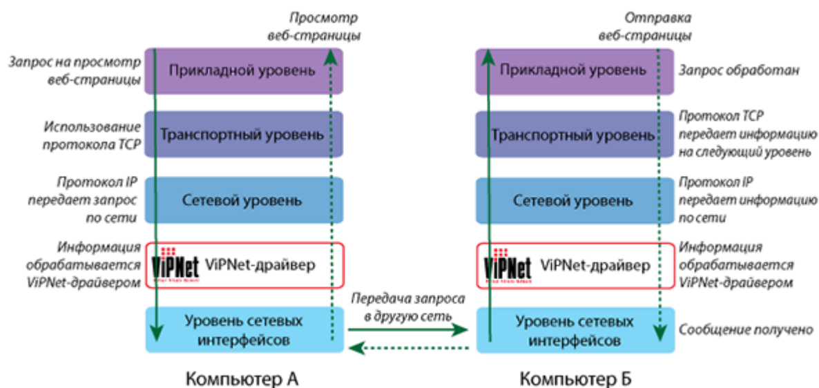
Рисунок 2. Схема работы сети TCP/IP, защищенной ПО ViPNet
