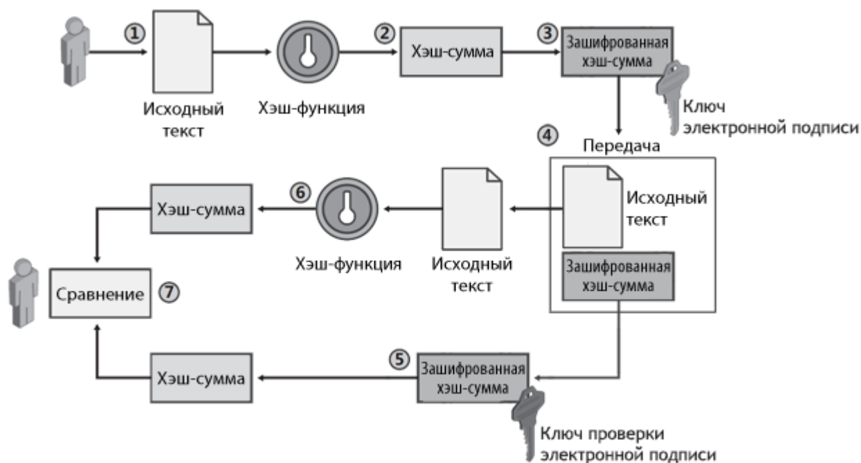
Рисунок 155. Применение хэш-функции и асимметричного криптографического алгоритма в электронной подписи
